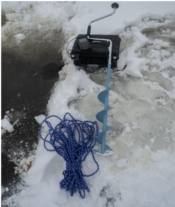
Abbildung 2: Eisbohrer, Sauerstoffmessgerät und Sicherungsseil – Wichtiges Equipment zur Überwachung der Gewässer. Foto: Matthias Emmrich, AVN
